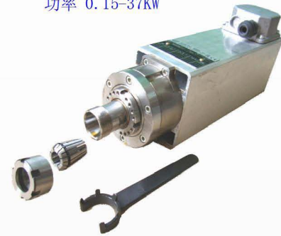
三相高轉速電機 輸入 12000/18000/24000rpm 功率 0.22-8.0KW 200/300/400Hz
